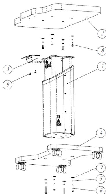
Рис. 1.3 Состав Столика, вариант исполнения: Stern Lift 2
