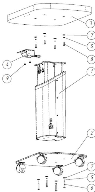
Рис. 1.1 Состав Столика, вариант исполнения: Stern Lift
