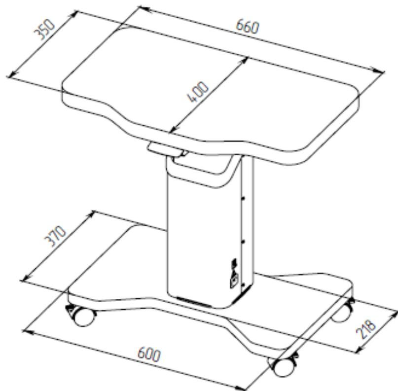
Рис. 3.3 Виды и габаритные размеры Столика Stern Lift 2
