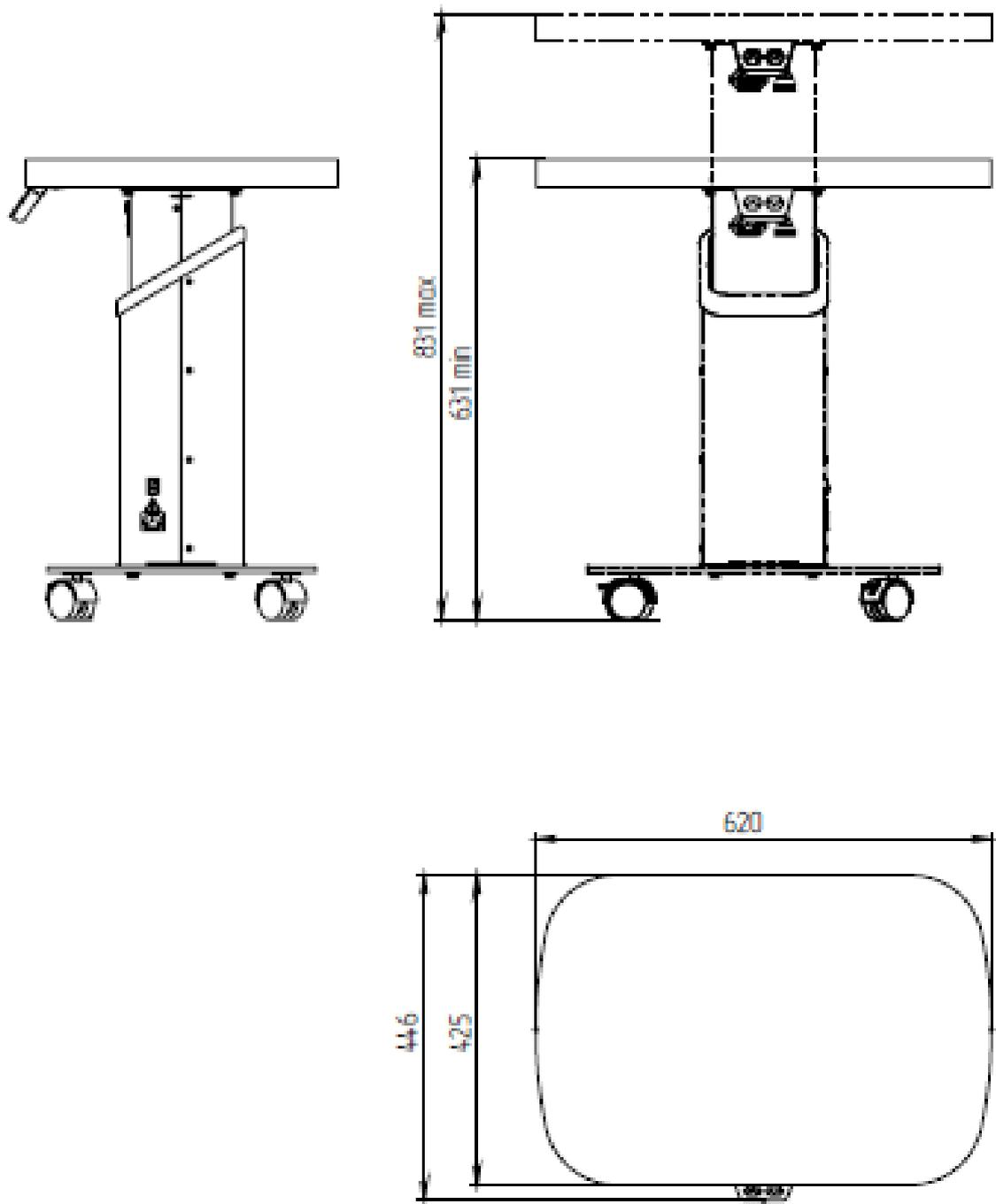
Рис. 3.2 Виды и габаритные размеры Столика Stern Lift Sensor
