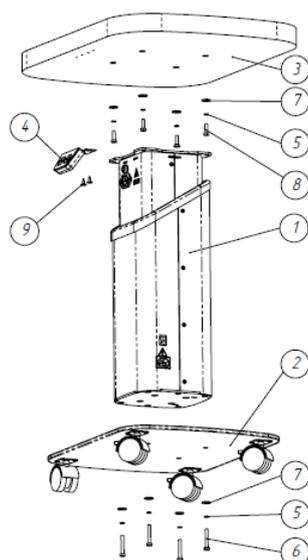
Рис. 1.2 Состав Столика, вариант исполнения: Stern Lift Sensor
