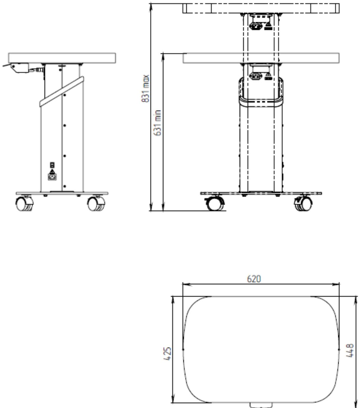
Рис. 3.1 Виды и габаритные размеры Столика Stern Lift
