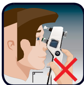
Неправильное положение тонометра и красная световая индикация на держателе наконечника.
