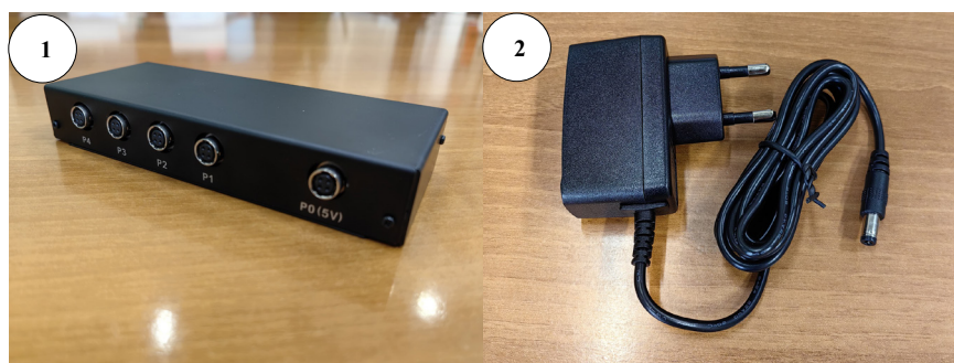
[Рисунок 5-13] Преобразователь UNICOS Тип М и его комплектующие
