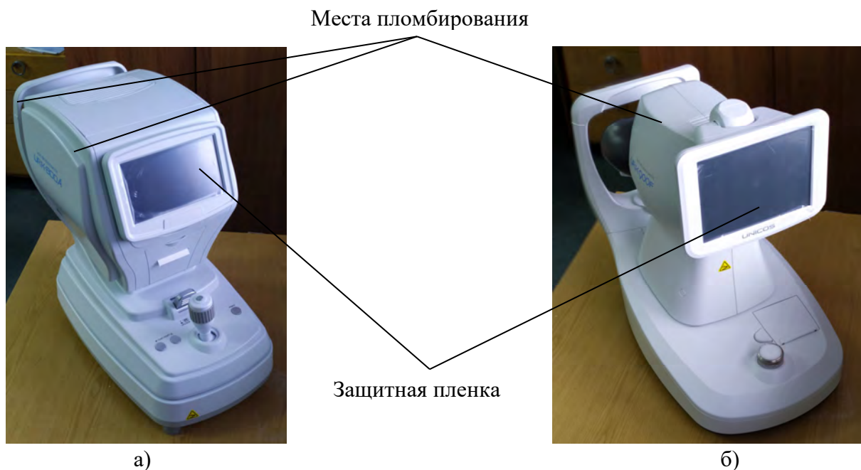
Рисунок 1 – Общий вид и схема пломбирования от несанкционированного доступа авторефрактометров: а) модель URK-800A б) модель URK-900F
