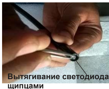
Фото 31 а Замена светодиода
