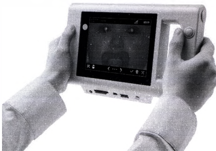
Рис. 8. Способ держания камеры и управления кнопкой «Пуск»
