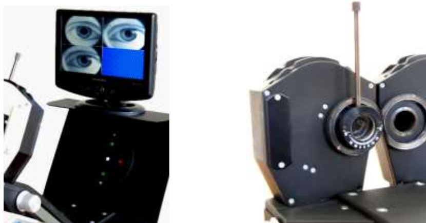
Рисунок 16 Призмный компенсатор, установленный в аппарате
