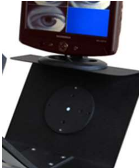
Рисунок 11 – Аппарат «ФОРБИС» в положении работы с растровым разделением полей зрения
