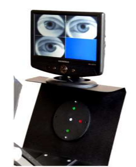
Рисунок 7 – Основное положение аппарата с цветовым четырехточечным тестом
