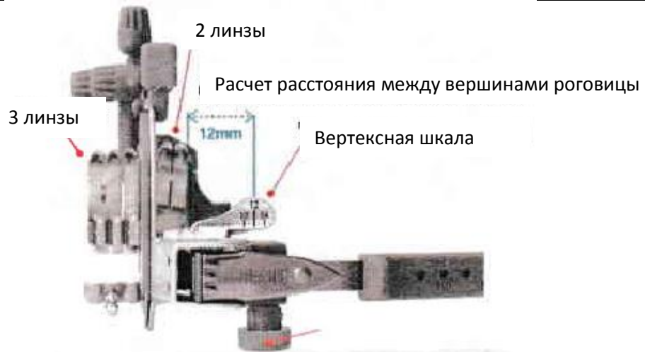
Винт регулирующий угол наклона носового упора
