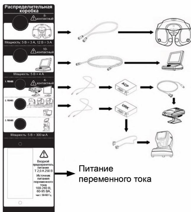
[Рисунок 4-11] Схема подключения UDR-800A
