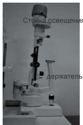
Фото 7а Крепление осветительной стойки и держателя
