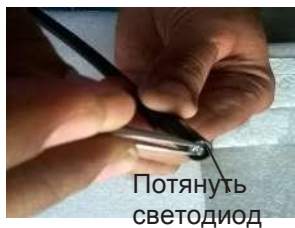
Фото 30 а Замена светодиода
